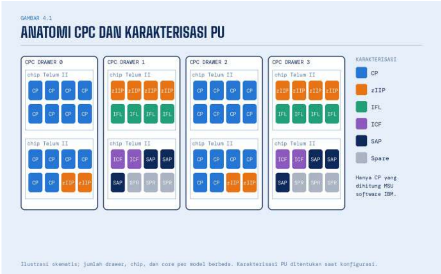
Gambar 4.1 — Anatomi CPC dan karakterisasi PU
