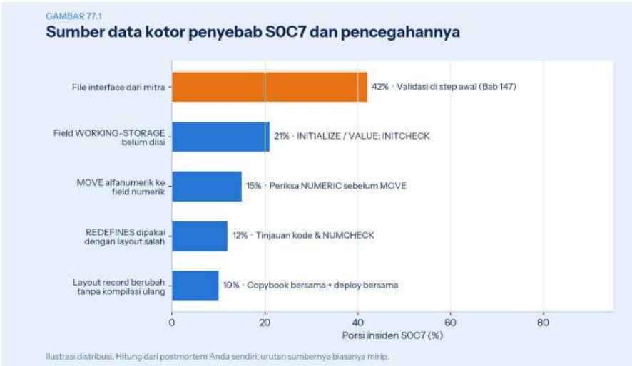
Gambar 77.1 — Sumber data kotor penyebab SOC7 dan pencegahannya
